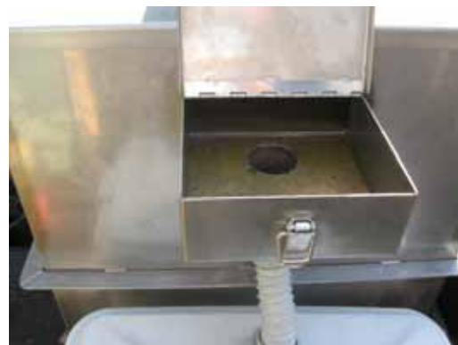
油排出部と回収タンク
